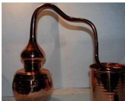
Figura 9. Destilador de laboratorio y alambique
