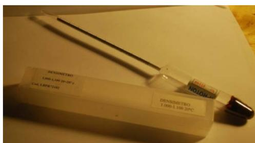
Figura 2a. Densímetro 1,000-1,100. La cuarta cifra se obtiene por interpolación
