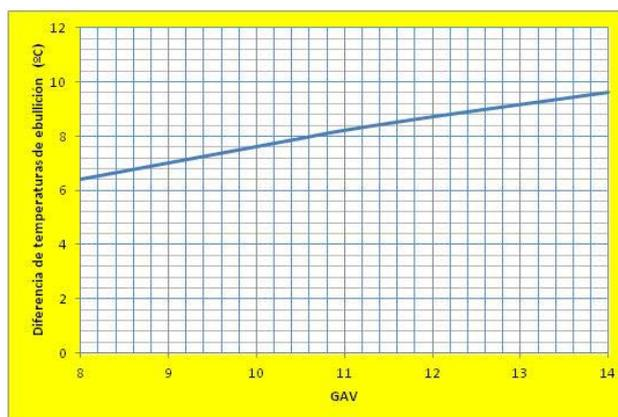
Figura 11. Curva patrón del ebullómetro
