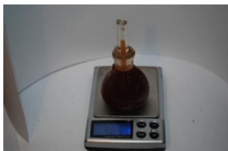
Figura 4a. El picnómetro en acción
