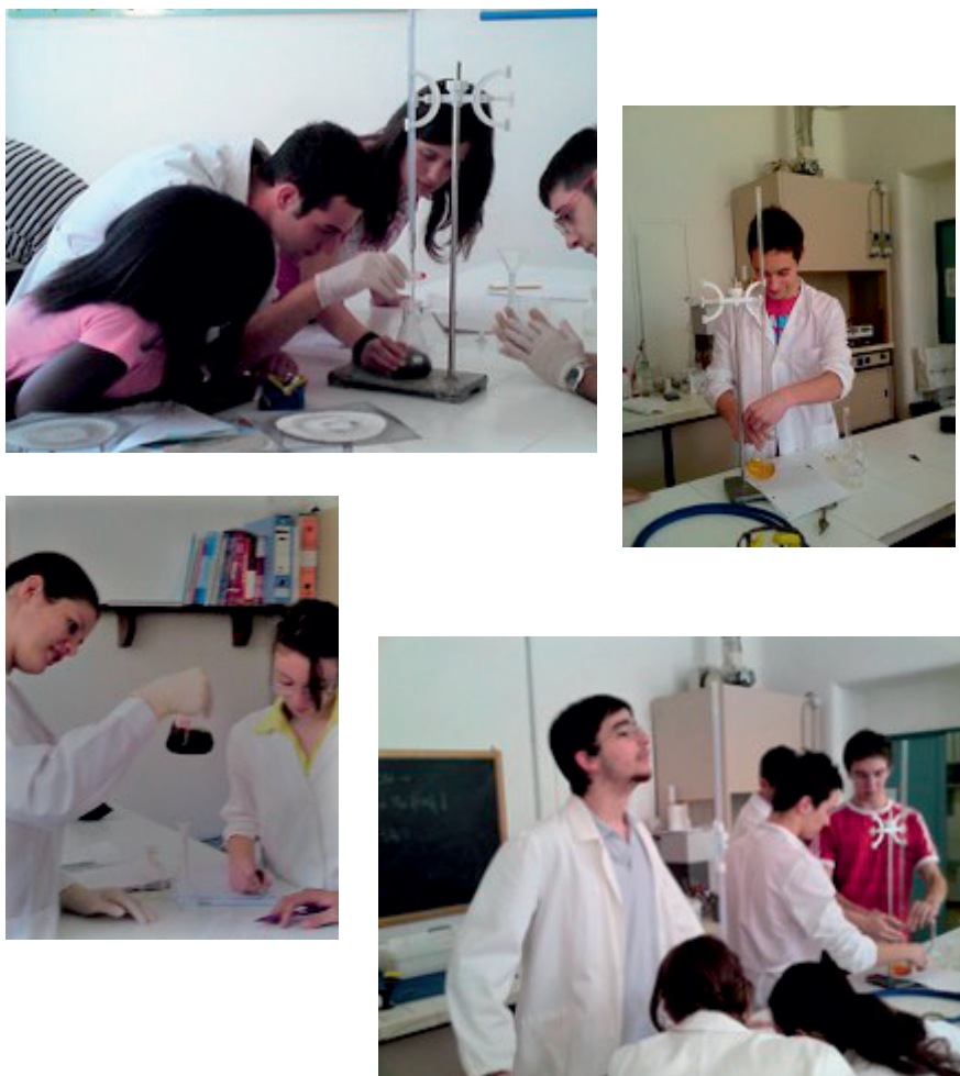
Figura 4. Determinazione dell'ossigeno disciolto col metodo di Winkler: riduzione dell' O_2 con Mn^{2+} e titolazione iodometrica.
