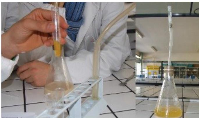
**Figura 11.** La determinazione dell'etanolo con  $K_2Cr_2O_7$  e con alcool test monouso.
