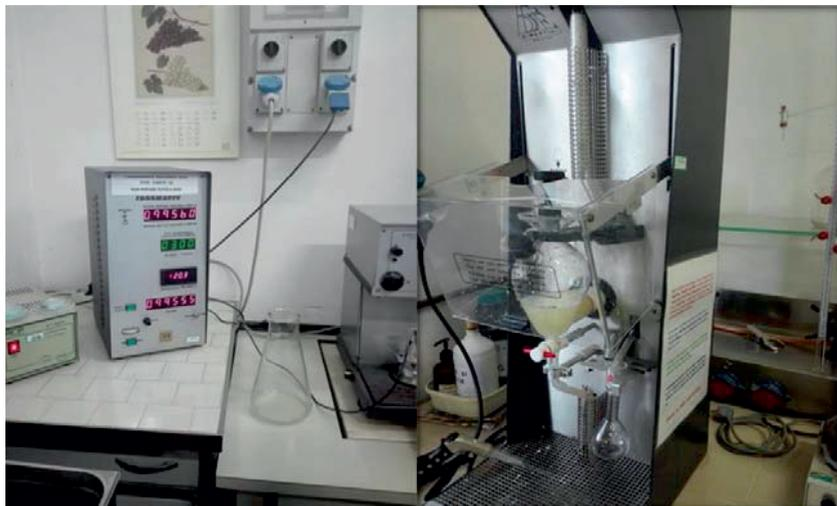
**Figura 10.** Bilancia idrostatica per misurare la quantità di alcool e distillatore.
