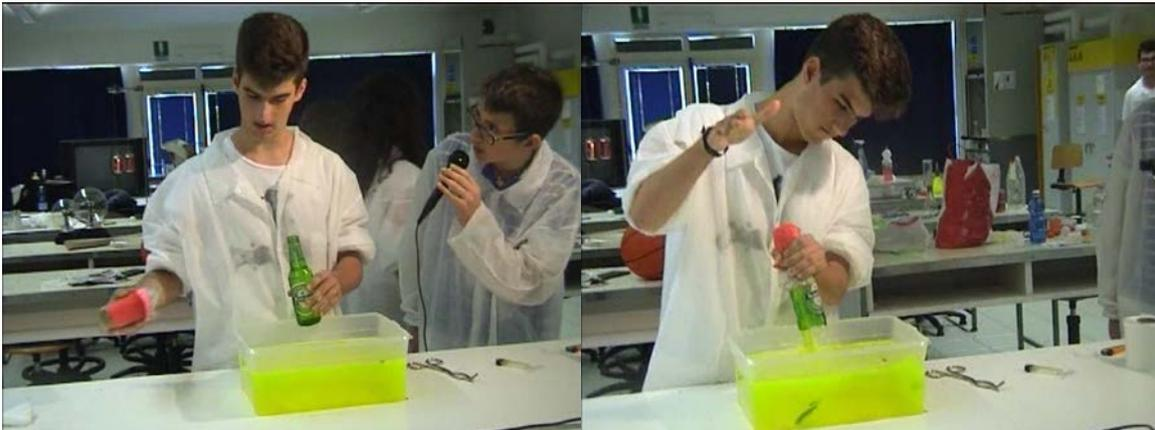
Figura 1. Bottiglia di birra rotta con colpo secco come conseguenza del Principio di Pascal
